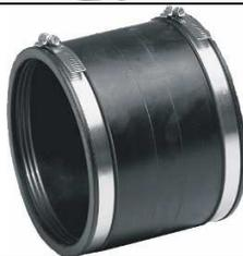
*Giunto di collegamento elastico in gomma MDC con fascette di tenuta in acciaio inox AISI 304 ; è la soluzione economica per montare condotte in un sistema elastico per garantire la perfetta tenuta idraulica e al contempo assorbire e compensare disassamenti, cedimenti e vibrazioni di condotte aeree; pressione max 0,6 bar*
