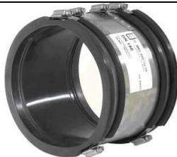
*Giunto di collegamento elastico in gomma MSC con fascette di tenuta e rinforzo centrale in acciaio inox AISI 304 ; è la soluzione tecnicamente corretta per montare condotte in un sistema elastico per garantire la perfetta tenuta idraulica e al contempo assorbire e compensare disassamenti, cedimenti e vibrazioni di condotte aeree; pressione max 2,5 bar*
